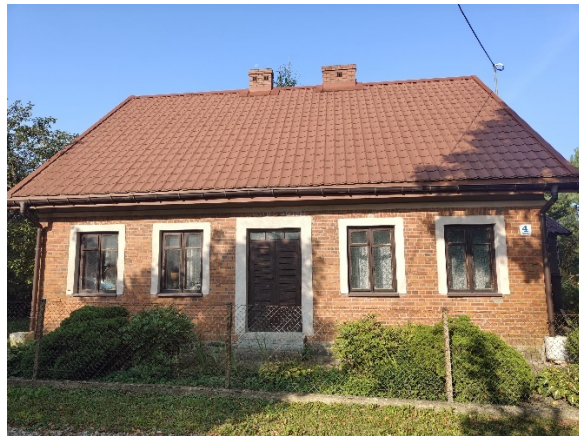
Zdjęcie 12. Budynek mieszkalny z początku XX wieku w miejscowości Zdedy. Przykład nietynkowanej, ceglanej zabudowy szerokofrontowej o symetrycznej elewacji. Fot. własna, 2024
